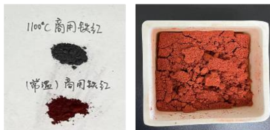
在高温下，商用铁红等颜料出现明显变色，本项目拟放大制备颜料热稳定性优异
